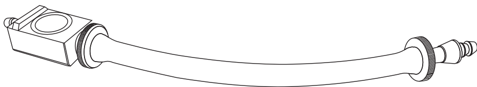
Рисунок 6. Нагнетательная трубка в сборе с датчиком давления, силиконовой мембраной, трубкой силиконовой (8×12 мм, длиной 185 мм) и штуцером.
