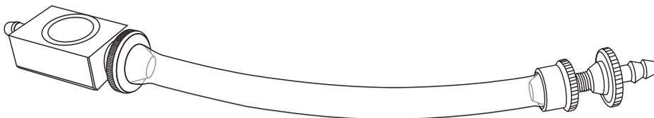
Рисунок 3. Нагнетательная трубка в сборе с датчиком давления, силиконовой мембраной, трубкой силиконовой (8×12 мм, длиной 215 мм) и штуцером.
