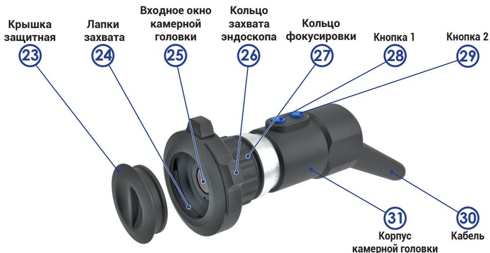
Рисунок 3. Видеокамера эндоскопическая ЭВК-005-«ЭлеПС». Камерная головка с объективом с фиксированным фокусным расстоянием.
